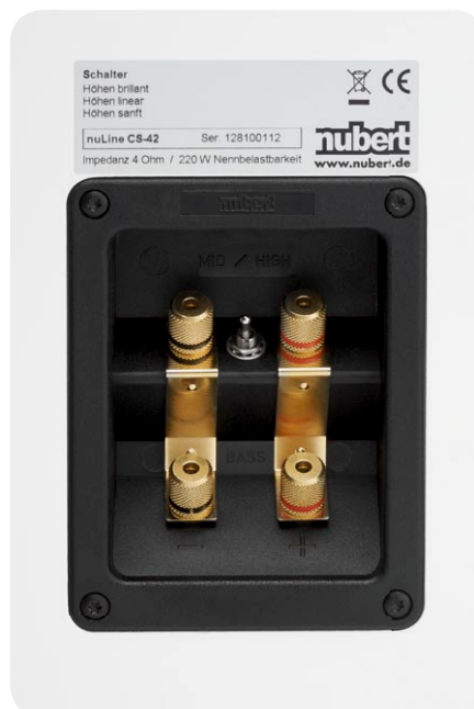
Per Metall-Kippschalter lässt sich der Klangcharakter eines nuLine-Lautsprechers zwischen sanft, linear und brillant einstellen
