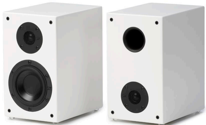
Die kleinen DS 22-Surroundlautsprecher sind als Dipole gebaut. Ein Zweiwegesystem strahlt nach vorne ab, ein Hochtöner und Reflextunnel nach hinten
