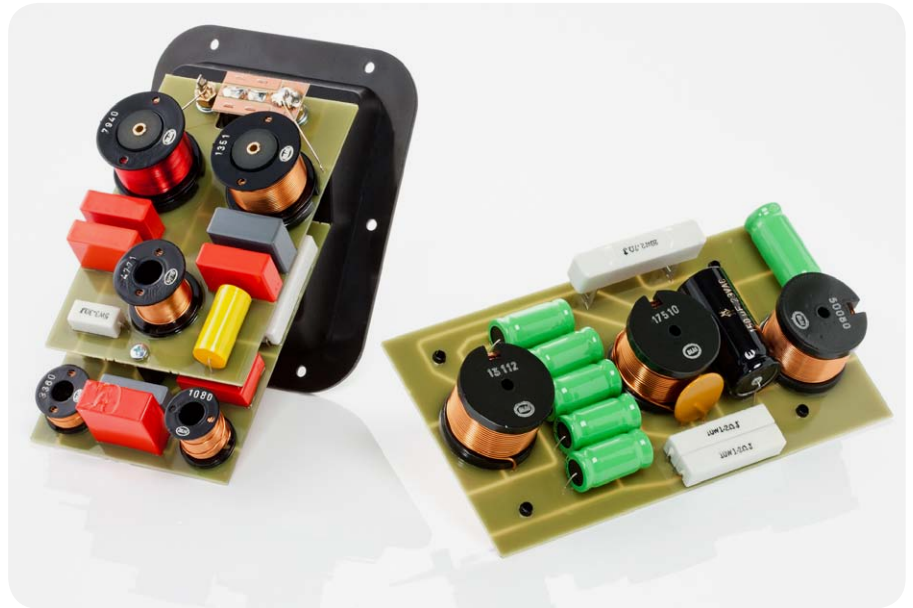
Bei der nuLine 284 besitzt jeder Weichenzweig seine eigene Platine
