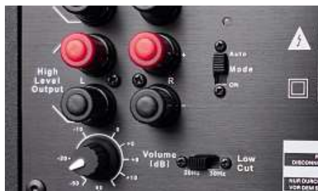
Auto-on: In der Schalterstellung „Auto“ schaltet sich der Subwoofer automatisch ein, sobald ein Signal am Eingang anliegt
