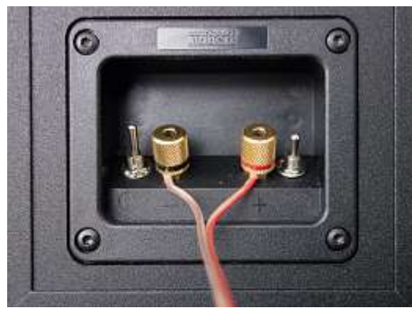
Klangschalter: Per Kippschalter neben den Schraubterminals lässt sich die Wiedergabecharakteristik der Satelliten verändern
