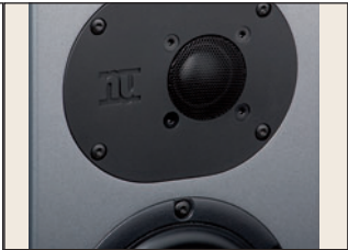
Unsymmetrischer Hochtöner für geringer ausgeprägte Schallbrechung an Kanten
