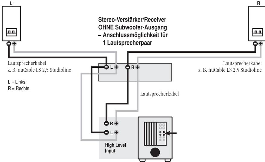
**Sie haben einen Stereo-Receiver/Verstärker ohne Line OUT bzw. Subwoofer-Ausgang:**
