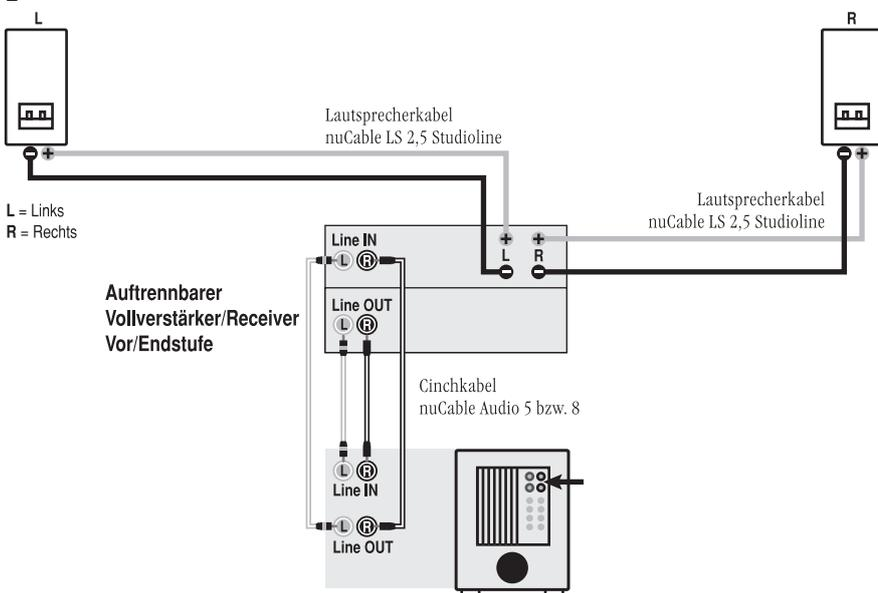
**Sie haben einen Vollverstärker mit auftrennbarem Vor/Endstufenteil bzw. eine Vor/Endstufenkombination mit Line-OUT- bzw. Line-IN-Buchsen:**
