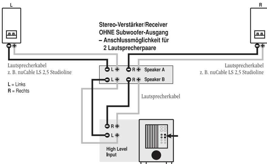
**1 b):** Wenn der Verstärker/Receiver Anschlüsse für *zwei* Lautsprecherpaare (*Speaker A* und *Speaker B*) hat, dann werden die Lautsprecher an den einen und der AW-1000 an den anderen Speaker-Anschluss angeschlossen und beide Lautsprecherpaare eingeschaltet.
