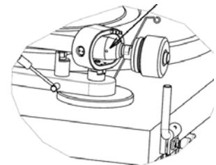
Dazu stellen Sie das Geodreieck mit seiner Basislinie auf den Plattenteller und richten die Oberkante des Tonabnehmergehäuses an den Parallellinien aus.
