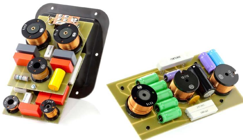
Die Dreiwegen-Frequenzweiche ist Nubert-typisch aufwändig gestaltet und mit soliden Passivbauteilen bestückt
