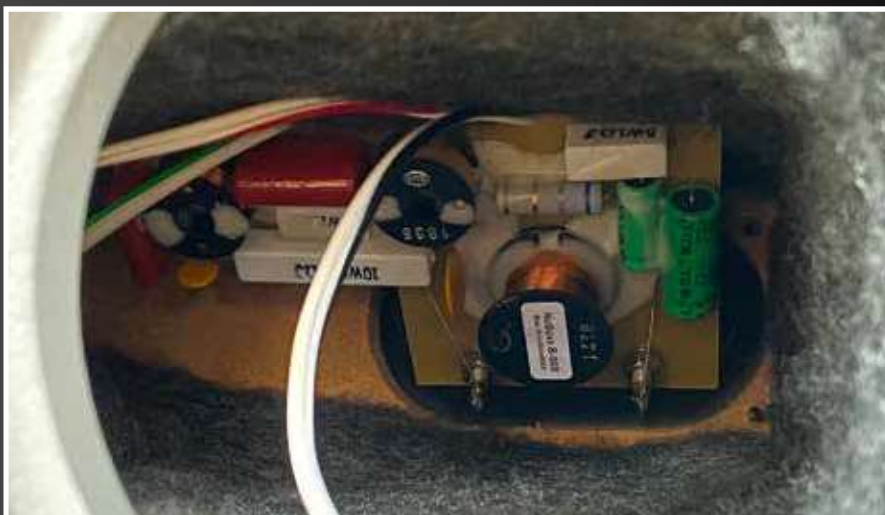
Einfach mal den Treiber ausbauen und einen Blick auf die neue Frequenzweiche werfen. Extra für Nubert entwickelte Bauteile, hochwertig und gewissenhaft ausgeführt
