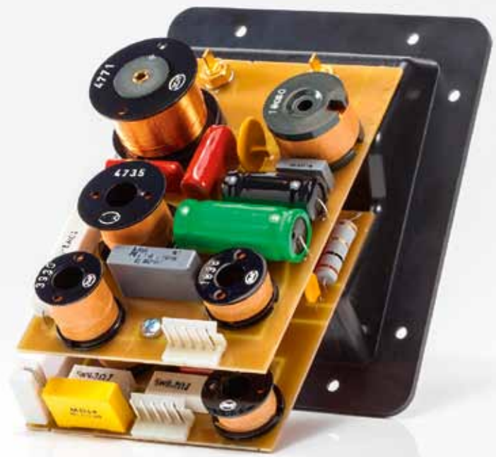
Die Weiche ist besonders aufwendig bestückt – auch wegen der diversen zuschaltbaren Filtermöglichkeiten und des Dipols.
