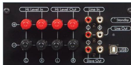
Der Subwoofer lässt sich dank seiner vielen Anschlüsse mit beinahe allen Boxentypen und Verstärkern kombinieren. Die USB-Buchse dient zu Servicezwecken.
