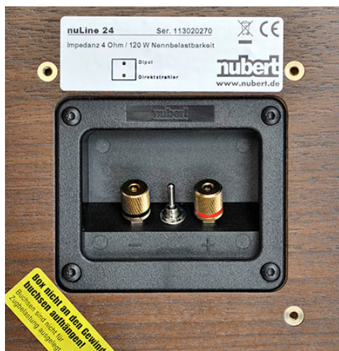
Zwischen den beiden grossen Lautsprecherklemmen in der Gehäuseunterseite findet sich hier auch der kleine Kippschalter, über den sich die nuLine 24 in einen Dipollautsprecher verwandeln lässt.
