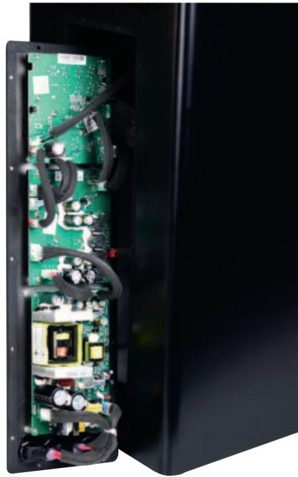
Analoge Cinch-Eingänge und drei digitale Schnittstellen stehen bereit. Elektrisch und optisch nimmt die A-600 HiRes bis 96 kHz/24 Bit entgegen, per USB maximal 48 kHz/16 Bit.
