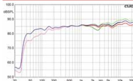
In dieser Messung erkennt man gut den Einfluss der drei Kippschalter für die individuelle Klangeinstellung der nuVero 10. Bass-, Mitten und Hochtonbereich lassen sich anheben bzw. absenken. Generell zeichnet sich die nuVero 10 durch einen tonal sehr ausgewogenen Frequenzgang aus.
