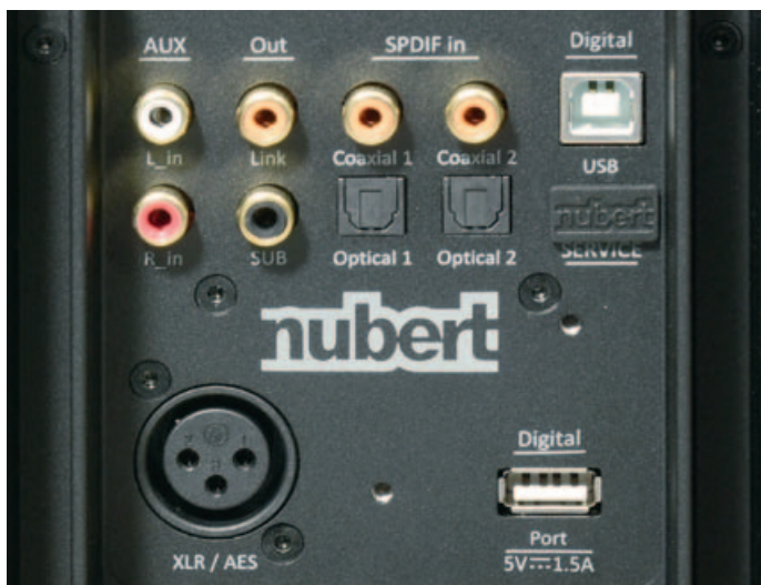
Kein Zauber, aber schlaue Reduktion. Ein moderner, aktiver Lautsprecher wird nicht nur per Cinch bedient, sondern auch per XLR und USB.
