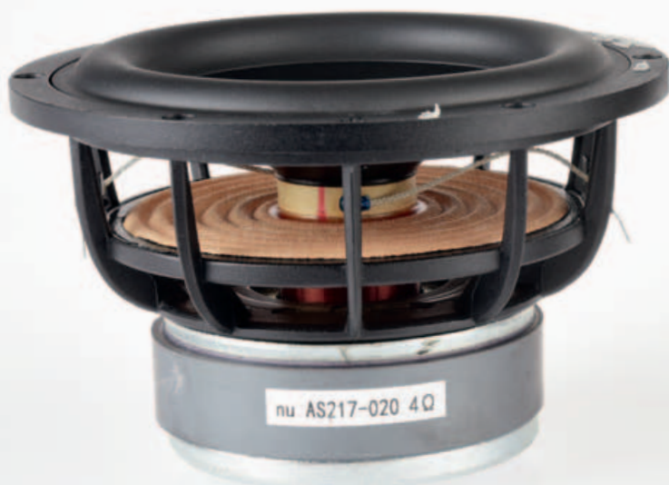
Suchbild: Wo ist der Unterschied? Es gibt ihn nicht. Gleich drei Typen dieses Chassis verbaut Nubert in seiner nuPro X-6000 RC. Hierüber wird die Mitte gestemmt. Aber die Polypropylen-Membran bringt auch einen enormen Hub auf, um die Bässe in den Klangraum zu wuchten. Insgesamt eine schlaue Kombination.
