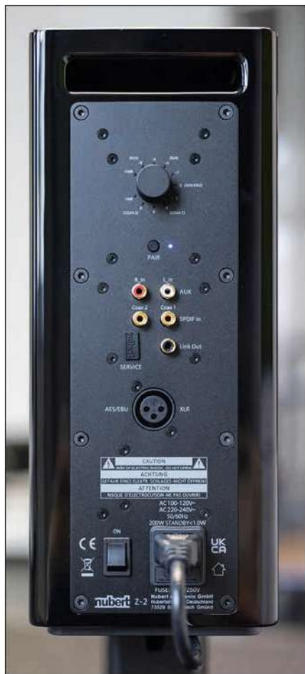
Die nuZeo 3 hat vielfältige Anschlussmöglichkeiten: 2×Coax [digital], 1×Cinch (Stereo-analog), 1×XLR/AES (symmetrisch, analog oder digital) und den kabellosen X-Connect-Funkstandard
