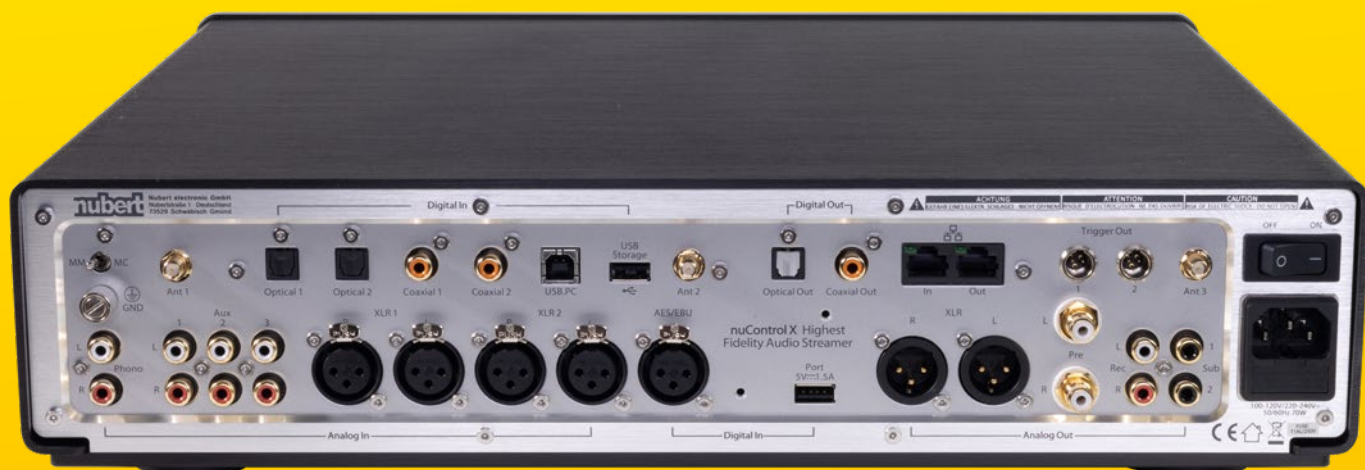
Hier ist gut die zweistöckige Aufteilung des nuControl X in digital und analog zu erkennen: Oben sind die digitalen Anschlüsse und unten die analogen
