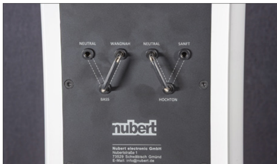
Auf der Rückseite der nuVero nova 5 finden wir, wie bei den anderen Lautsprechern der Serie, Brücken um die Höhen und den Bass abzusenken bzw. zu verstärken
