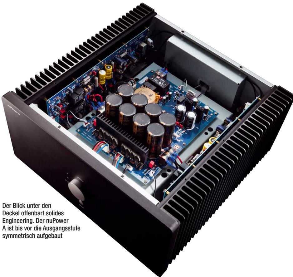
Der Blick unter den Deckel offenbart solides Engineering. Der nuPower A ist bis vor die Ausgangsstufe symmetrisch aufgebaut
