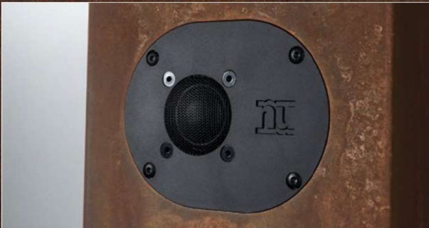
Der Hochtöner mit Seidengewebekalotte schaut am besten in Richtung seines Spielpartners - Dann steht der Lautsprecher auf der richtigen Seite
