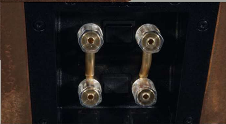
Das Anschlussterminal ist Bi-Wiring- und Bi-Amping-fähig. Außerdem gibt es zwei Wahl-schalter, um den Klang der nuLine 284 Jubilee anzupassen
