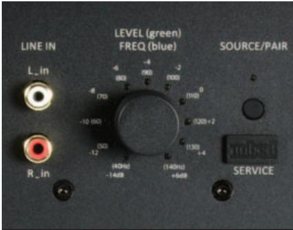
**ZWEI IN EINS:** Mit dem Drehregler lassen sich die Lautstärke und Trennfrequenz des XW-700 einstellen. Ein Druck auf den Regler schaltet zwischen den Funktionen um und lässt die LEDs entweder in Grün (Lautstärke) oder Blau (Trennfrequenz) erstrahlen.
