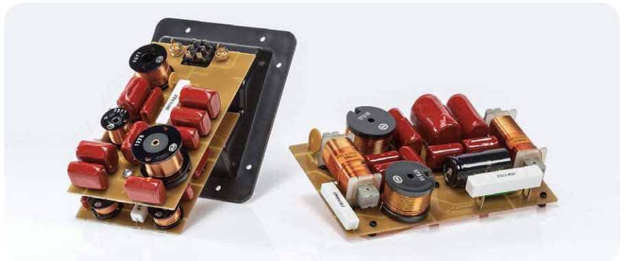
Die Frequenzweiche ist auf drei Platinen verteilt und mit hochwertigen Passivbauteilen bestückt
