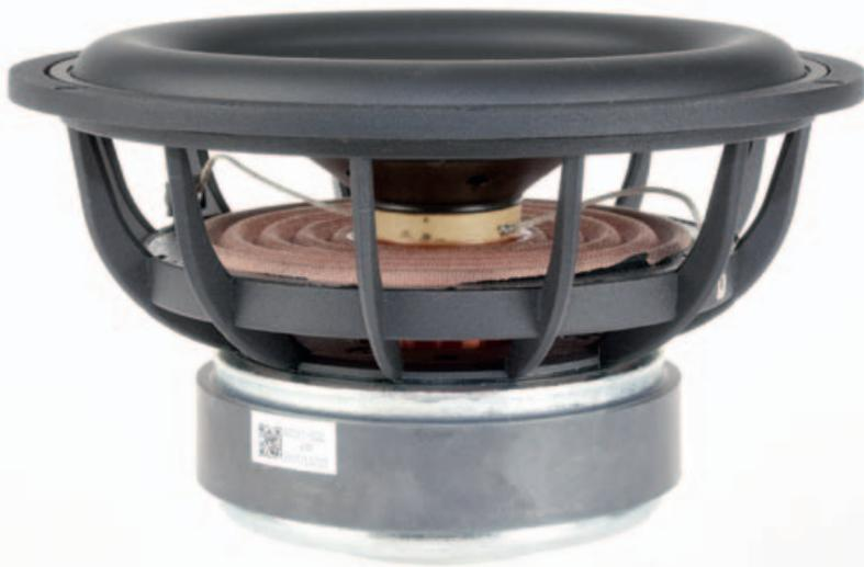
Da der Mitteltöner der X-8000 bei den kleineren X-Modellen auch als Tieftöner fungiert, sehen sich die beiden Wandler ziemlich ähnlich: Die Membran besteht aus faserverstärktem Polypropylen, ein kräftiger Magnet, überhängende Spulen und mächtige Sicken erlauben große Auslenkungen. Für maximale Belastbarkeit lässt der stabile Druckguss-Korb dem Chassis viel Luft.
