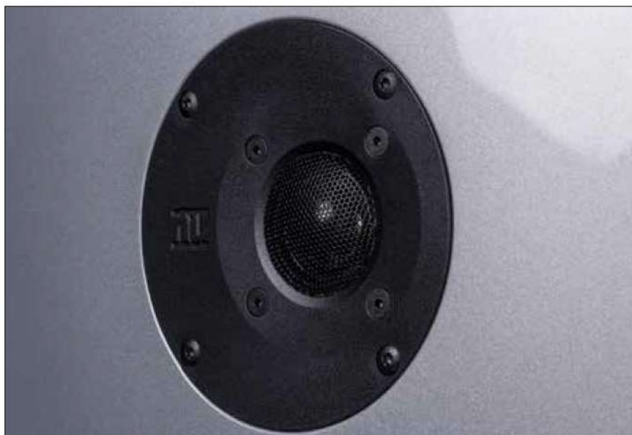
Der 26 Millimeter Hochtöner mit Seidengewebekalotte zeigt an, ob die nuVero 170 richtig stehen, er muss zur Mitte „schielen“
