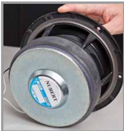
Der mit 180 Millimeter sehr großzügig dimensionierte Tieftöner sorgt für einen opulenten Bassbereich
