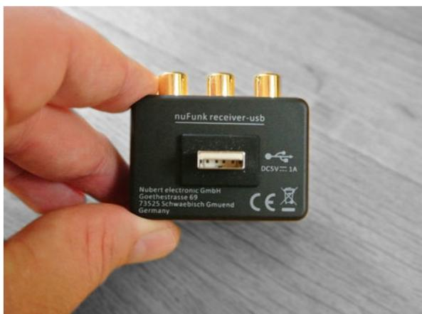
Das Empfängermodul Nubert nuFunk EU-1: der USB-Anschluss dient ausschließlich der Stromversorgung
