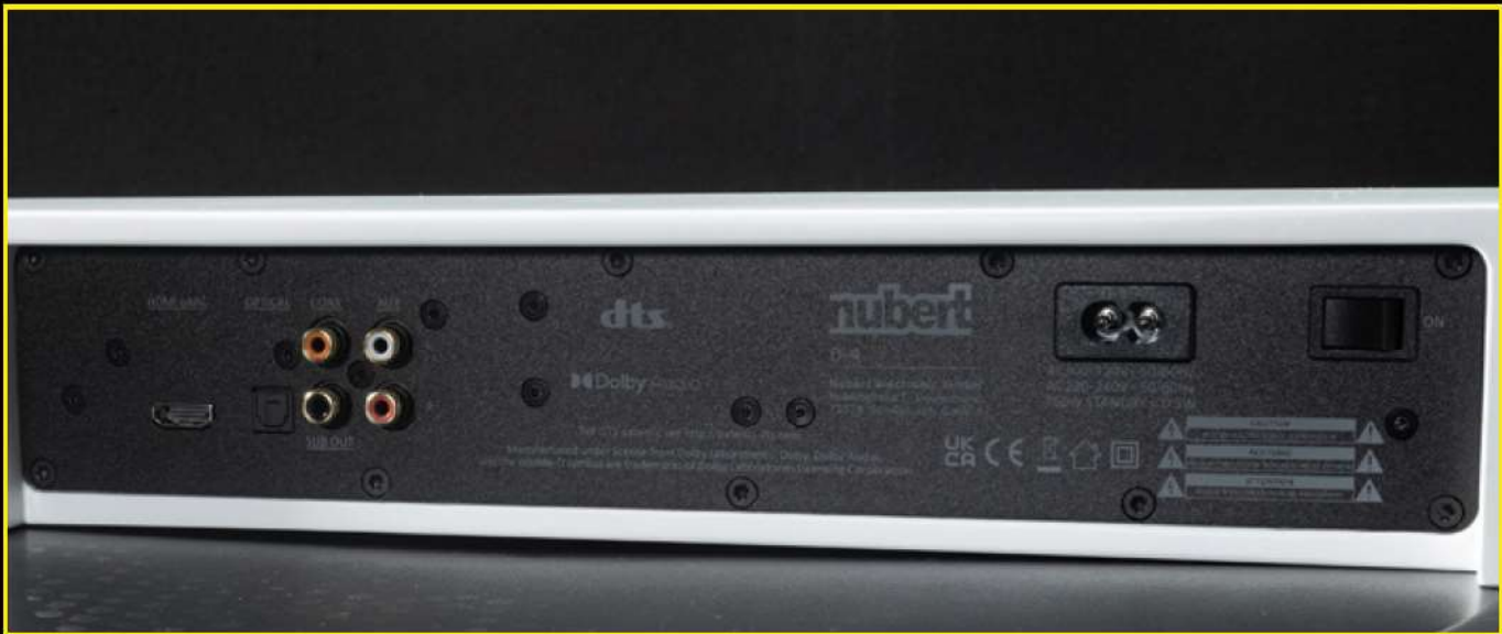
An Anschlüssen bietet die nuPro AS-2500 neben HDMI eARC auch Cinch sowie einen optischen und koaxialen Eingang. Ein Subwoofer lässt sich hier ebenfalls anschließen
