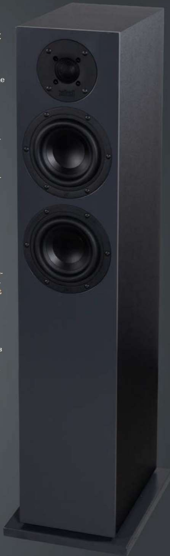
Die zwei Longstroke-Tieftöner mit Polypropylenmembran erlauben in Kombination mit dem Bassreflexsystem eine Tieftonwiedergabe ab 31 Hz (-6 dB)
