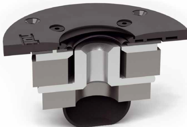
Der Hochtöner mit Doppel-Magnet-System und angekoppeltem Volumen
