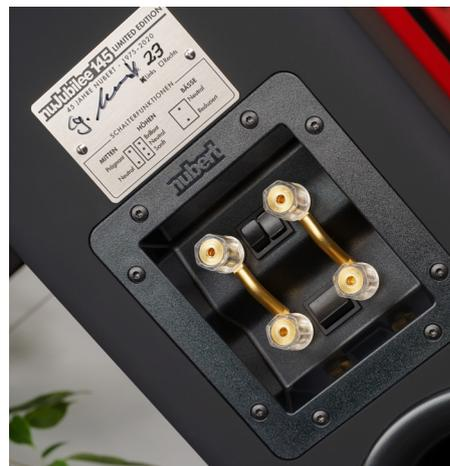
Das Anschlussfeld ist mit massiven Schraubklemmen in Bi-Wire-Anordnung und drei kleinen Tastern ausgerüstet, die eine Klanganpassung im Hoch-, Mittel- und Tiefbassbereich erlauben. Die oberhalb platzierte Plakette gibt Auskunft über die Auswirkung der Schalterumstellung. Auf der Plakette ist zudem die Unterschrift Günther Nuberts angebracht. Ein weiterer Unterschied zur klassischen nuVero 140.
