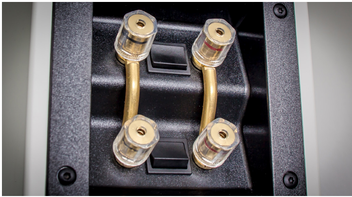
Zwei Schalter für den Wunsch-Klang: Mit der Höhen- und Bassbeeinflussung kann man Defizite des Raums beheben oder seine Soundvorstellungen realisieren.
