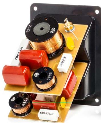
Die 2,5-Wege-Frequenzweiche ist auf mehrere Platinen verteilt, wodurch Nubert eine exzellente Signaltrennung erreicht
