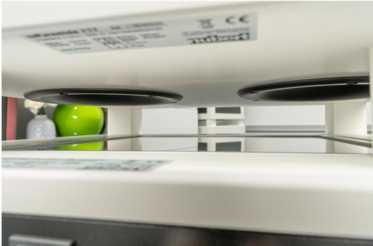
Unter dem eigentlichen Pyramidenkorpus sitzen die beiden kreisrunden Ports der Bassreflexabstimmung. Hier findet ein Luftaustausch zwischen dem Boxenvolumen und der Umgebung statt, mit diesem Verfahren wird der Tieftone eines Lautsprechers abgestimmt.
