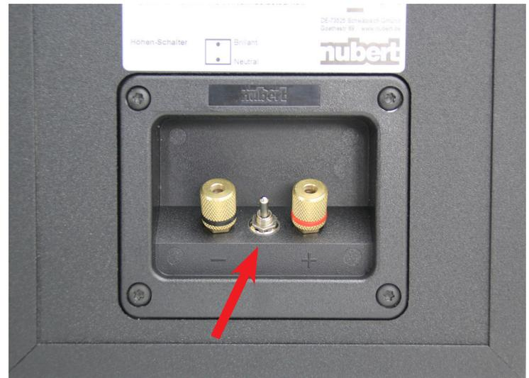
Der kleine Kippschalter zwischen den beiden massiven Anschlussbuchsen dient der Hochtonanpassung. In stark gedämpften Räumen empfiehlt sich die Schalterstellung „brillant“, während „normal“ in klassisch gestalteten Wohnräumen in der Regel eher die beste Hochtonperformance bietet.
