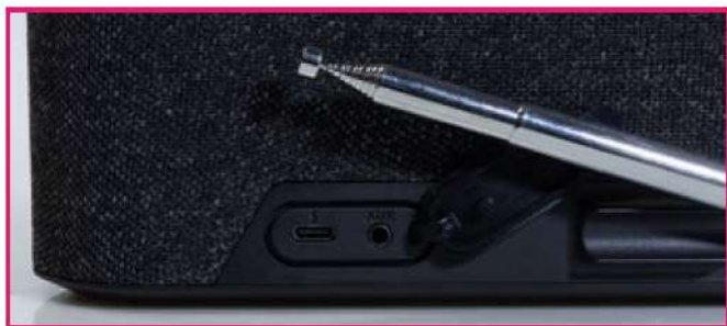
Unter der Gummiabdeckung finden wir den UBS-C-Anschluss, über den wir den internen Akku laden
