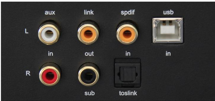
Die Anschlusssektion: Die nuPro A-500 ist mit einem analogen und drei digitalen Eingängen ausgestattet. Ein Subwoofer-Ausgang ist ebenfalls vorhanden.
