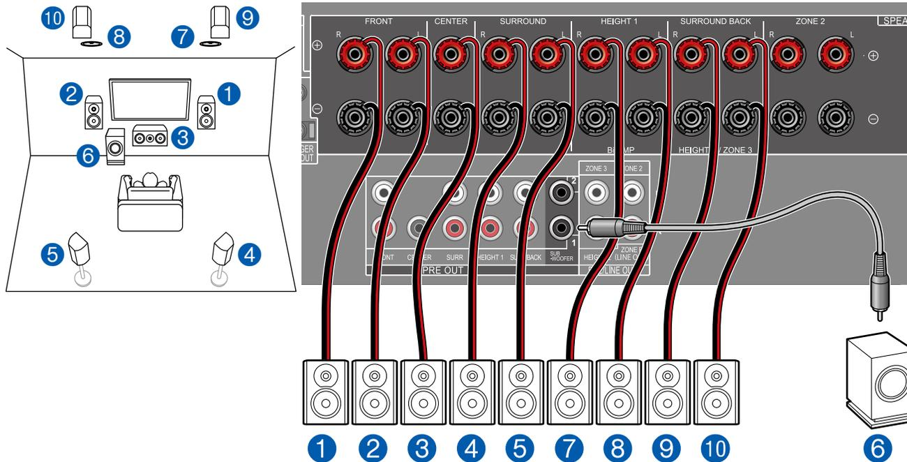
Dies ist ein Beispiel der Kombination der oberen Mittellautsprecher vorne und den Rückhöhenlautsprechern hinten mit dem 5.1-Kanalsystem. Die Höhenlautsprecher vorne können unter den folgenden 4 Typen gewählt werden. Die Höhenlautsprecher, die hinten kombiniert werden können, sind je nach den vorne verwendeten Höhenlautsprechern unterschiedlich.
