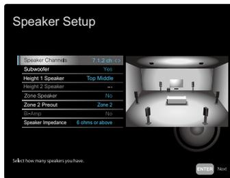
2. Die in Schritt 1 gewählte Lautsprecherkombination wird angezeigt. "Yes" wird für die gewählten Lautsprecher angezeigt. Wenn die Einstellung richtig ist, drücken Sie ENTER.
