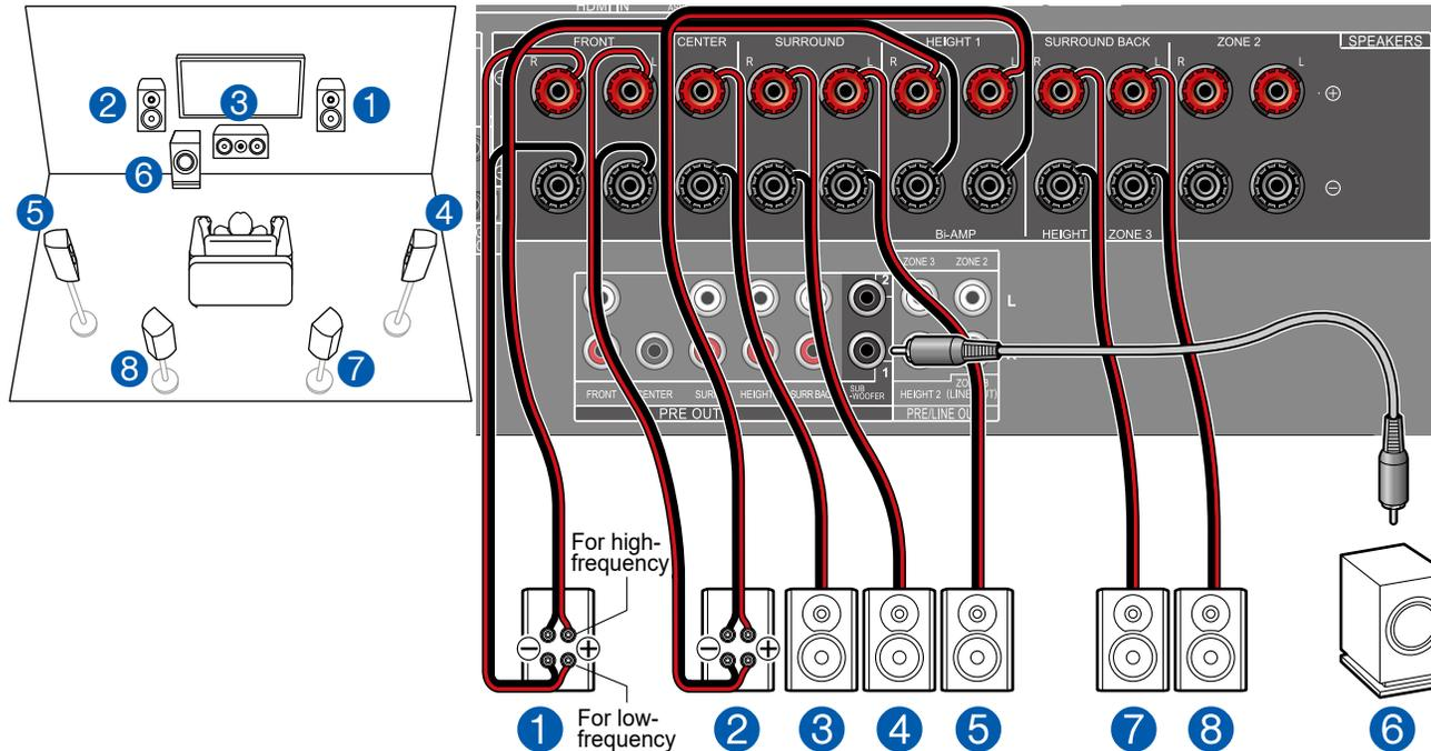
Sie können ein 7.1 Kanalsystem (→p21) durch den Anschluss der Frontlautsprecher, die die Bi-Amping-Verbindung unterstützen, konfigurieren. Die Bi-Amping-Verbindung kann die Qualität der niedrigen und hohen Bereiche verbessern. Stellen Sie sicher, dass die Leitungsbrücke zwischen den Tieftönerbuchsen und den Hochtönerbuchsen der Frontlautsprecher, die eine Bi-Amping-Verbindung unterstützen, entfernt werden. Entsprechende Informationen finden Sie auch in der Bedienungsanleitung Ihrer Lautsprecher.
