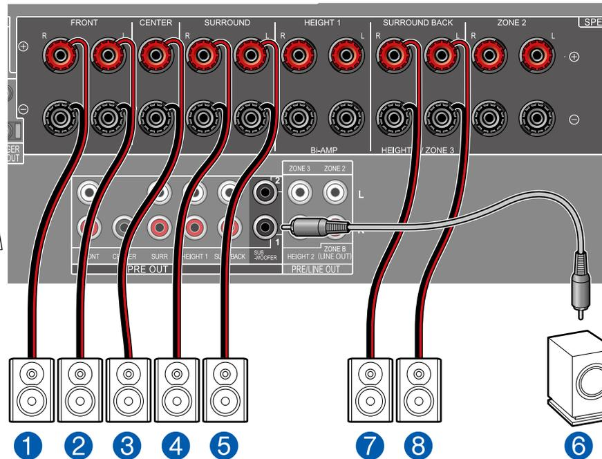
Dies ist ein 7.1-Kanalsystem, das aus dem grundlegenden 5.1-Kanalsystem und zusätzlichen Surround-Back-Lautsprechern besteht. Für Einzelheiten der Lautsprecherkonfiguration lesen Sie bitte "Lautsprecherinstallation" (→p21).
