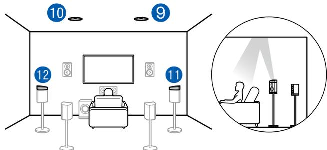
Die Dolby-aktivierten Lautsprecher sind die speziellen Lautsprecher, deren Klang zur Decke ausgegeben wird, und sie haben die Wirkung, dass der Klang durch Reflexion von oben von der Decke kommt.
