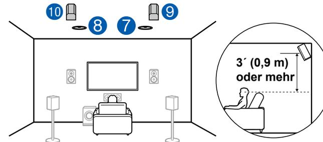
Der Abstand zwischen den Rückhöhenlautsprechern sollte dem der Frontlautsprecher entsprechen, und sie sollten mindestens 3'/0,9 m höher als die Frontlautsprecher installiert und geneigt werden, so dass sie zum Hörer weisen.
