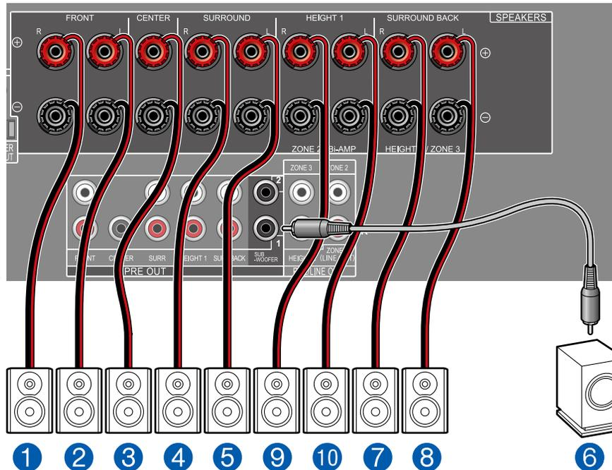
**MAIN ROOM:** Dies ist ein 7.1-Kanalsystem, das aus dem grundlegenden 5.1-Kanalsystem und zusätzlichen Surround-Back-Lautsprechern besteht. Für Einzelheiten der Lautsprecherkonfiguration lesen Sie bitte "Lautsprecherinstallation" (→p21).
