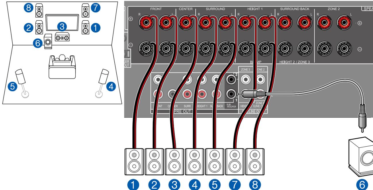
Dies ist eine Kombination aus dem 5.1-Kanalsystem und Front-Höhenlautsprechern. Ein Front-Höhenlautsprecher ist ein Typ vom Höhenlautsprecher. Sie können nur einen Satz von Höhenlautsprechern für den Anschluss unter den folgenden drei Typen auswählen.
