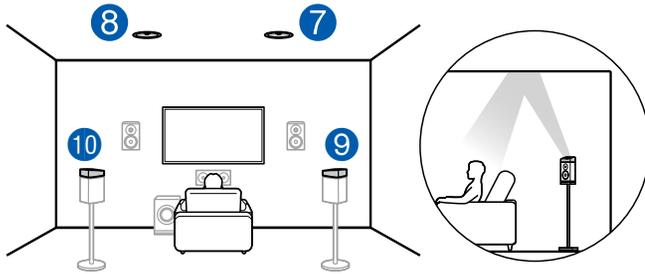
Die Dolby-aktivierte Lautsprecher sind die speziellen Lautsprecher, deren Klang zur Decke ausgegeben wird, und sie haben die Wirkung, dass der Klang durch Reflexion von oben von der Decke kommt.
