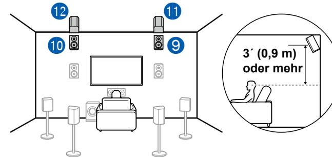
Der Abstand zwischen den Rückhöhenlautsprechern sollte dem der Frontlautsprecher entsprechen, und sie sollten mindestens 3'/0,9 m höher als die Frontlautsprecher installiert und geneigt werden, so dass sie zum Hörer weisen.
