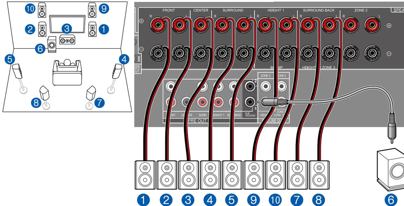
Dies ist eine Kombination aus dem 7.1-Kanalsystem und Front-Höhenlautsprechern. Ein Front-Höhenlautsprecher ist ein Typ vom Höhenlautsprecher. Sie können nur einen Satz von Höhenlautsprechern für den Anschluss unter den folgenden drei Typen auswählen.
