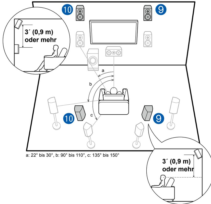
Dies ist ein 7.1-Kanalsystem (→p21) bestehend aus Frontlautsprechern, einem Center-Lautsprecher, Surround-Lautsprechern, Surround-Back-Lautsprechern und einem aktiven Subwoofer, sowie zusätzlichen kombinierten Front-Höhenlautsprechern oder Rückhöhenlautsprechern. Durch die Installation der Höhenlautsprecher wird das Klangfeldgefühl im oberen Bereich bereichert. Front- bzw. Rückhöhenlautsprecher sollten mindestens 3'/0,9 m höher als die Frontlautsprecher installiert werden.
