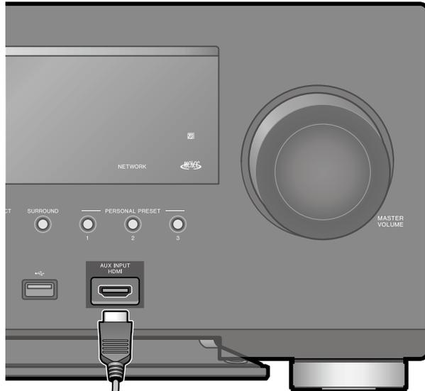
Schließen Sie eine Videokamera usw. an die AUX INPUT HDMI-Buchse am Bedienfeld mit einem HDMI-Kabel an.
