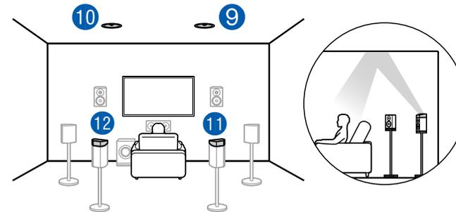
Die Dolby-aktivierten Lautsprecher sind die speziellen Lautsprecher, deren Klang zur Decke ausgegeben wird, und sie haben die Wirkung, dass der Klang durch Reflexion von oben von der Decke kommt.
