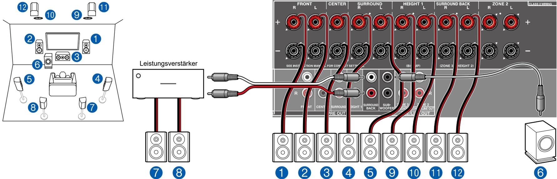
Dies ist ein Beispiel der Kombination der oberen Mittellautsprecher vorne und den Rückhöhenlautsprechern hinten mit dem 7.1-Kanalsystem. Die Höhenlautsprecher vorne können unter den folgenden 4 Typen gewählt werden. Die Höhenlautsprecher, die hinten kombiniert werden können, sind je nach den vorne verwendeten Höhenlautsprechern unterschiedlich.
