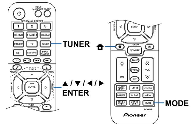
**Bei schlechtem FM-Senderempfang:** Führen Sie das Verfahren unter "Manuelle Sendersuche" ( → [p111](#)) aus. Beachten Sie, dass bei der manuellen Sendersuche der Empfang von FM-Übertragungen unabhängig von dessen Empfindlichkeit in Mono statt in Stereo erfolgt.
