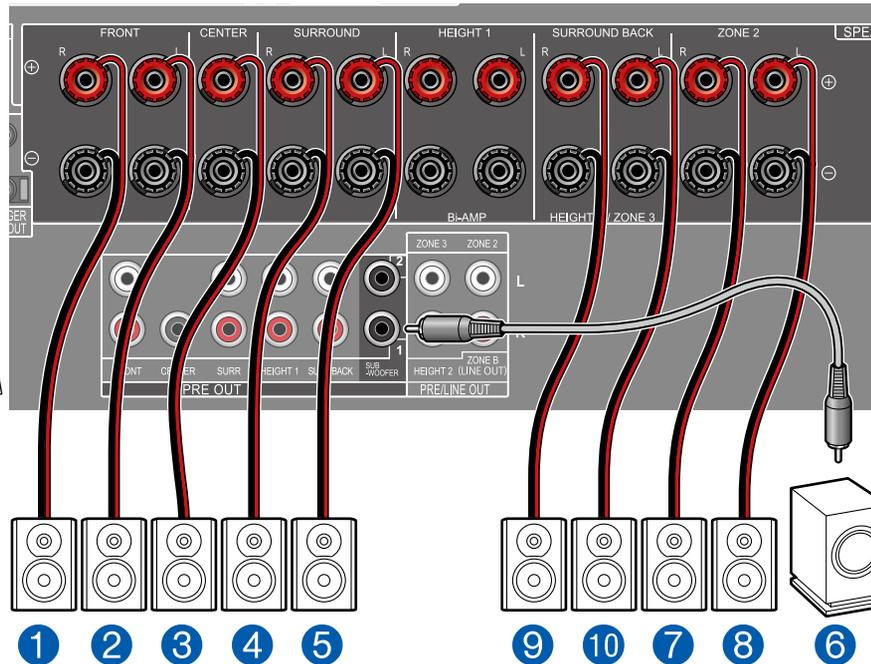
**MAIN ROOM:** Das ist ein Basis-5.1-Kanalsystem. Für Einzelheiten der Lautsprecherkonfiguration lesen Sie bitte "Lautsprecherinstallation" (→p20).
