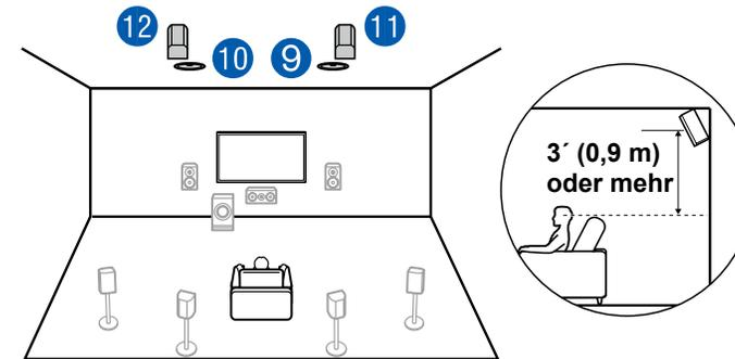
Der Abstand zwischen den Rückhöhenlautsprechern sollte dem der Frontlautsprecher entsprechen, und sie sollten mindestens 3' / 0,9 m höher als die Frontlautsprecher installiert und geneigt werden, so dass sie zum Hörer weisen.
