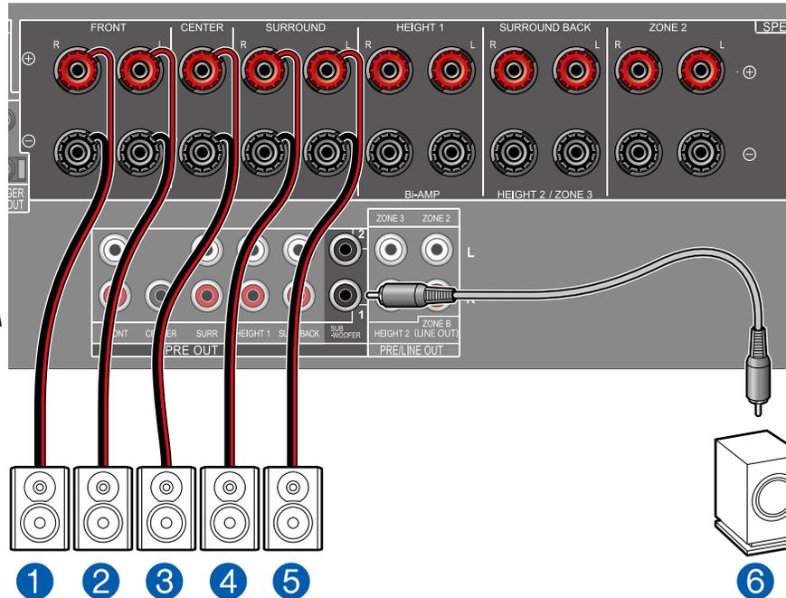
Das ist ein Basis-5.1-Kanalsystem. Für Einzelheiten der Lautsprecherkonfiguration lesen Sie bitte "Lautsprecherinstallation" (→p20).
