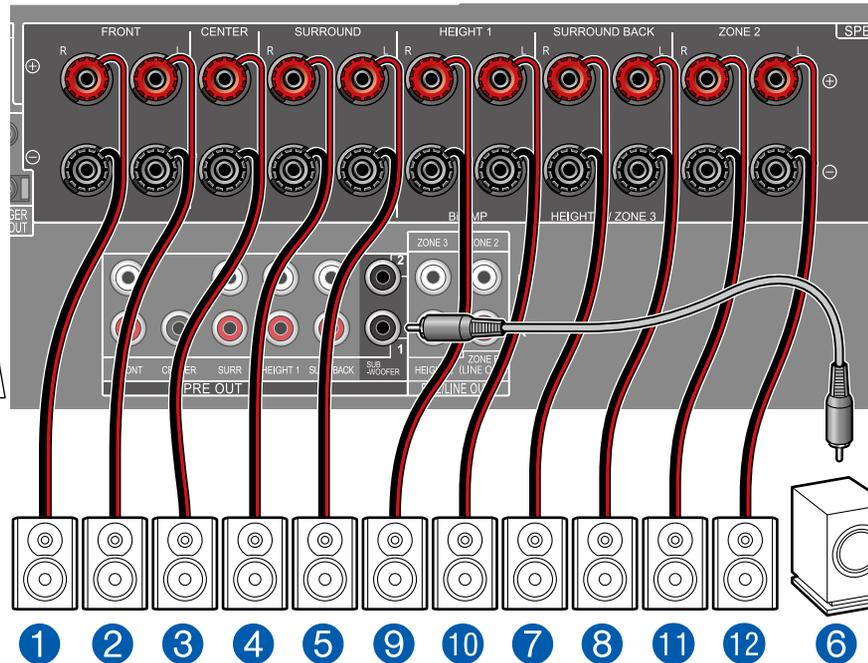
**MAIN ROOM:** Dies ist eine Kombination aus dem 7.1-Kanalsystem und Front-Höhenlautsprechern. Ein Front-Höhenlautsprecher ist ein Typ vom Höhenlautsprecher. Sie können nur einen Satz von Höhenlautsprechern für den Anschluss unter den folgenden drei Typen auswählen. (→p27)
