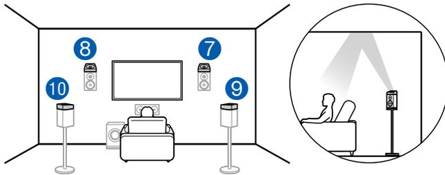
Die Dolby-aktivierten Lautsprecher sind die speziellen Lautsprecher, deren Klang zur Decke ausgegeben wird, und sie haben die Wirkung, dass der Klang durch Reflexion von oben von der Decke kommt.
