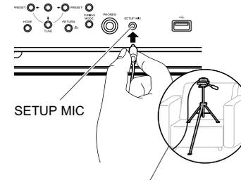
Wenn Sie das Messmikrofon zur Lautsprechereinrichtung auf einem Stativ platzieren, gehen Sie entsprechend der Abbildung vor.
