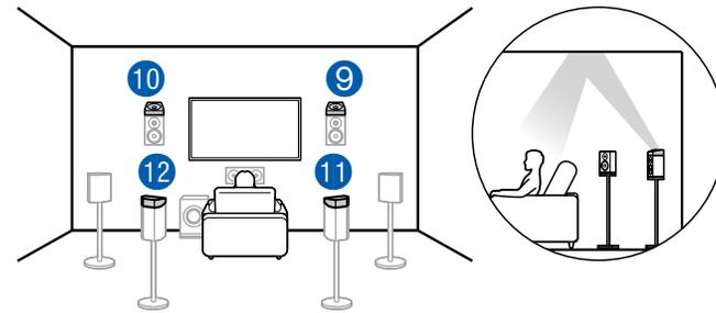
Die Dolby-aktivierten Lautsprecher sind die speziellen Lautsprecher, deren Klang zur Decke ausgegeben wird, und sie haben die Wirkung, dass der Klang durch Reflexion von oben von der Decke kommt.
