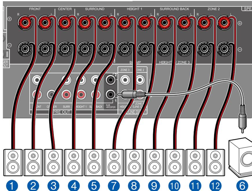
**MAIN ROOM:** Dies ist ein Beispiel der Kombination der oberen Mittellautsprecher vorne und den Rückhöhenlautsprechern hinten mit dem 5.1-Kanalsystem. Die Höhenlautsprecher vorne können unter den folgenden 4 Typen gewählt werden. Die Höhenlautsprecher, die hinten kombiniert werden können, sind je nach den vorne verwendeten Höhenlautsprechern unterschiedlich.
