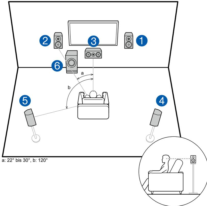
Das ist ein Basis-5.1-Kanalsystem. Über die Frontlautsprecher wird Front-Stereoklang ausgegeben, und ein Center-Lautsprecher gibt den Ton aus der Bildmitte wie Dialoge und Gesang aus. Die Surround-Lautsprecher erzeugen das hintere Klangfeld. Der aktive Subwoofer gibt Bassklänge wieder und erzeugt das volle Klangfeld.
