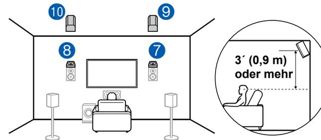
Der Abstand zwischen den Rückhöhenlautsprechern sollte dem der Frontlautsprecher entsprechen, und sie sollten mindestens 3' / 0,9 m höher als die Frontlautsprecher installiert und geneigt werden, so dass sie zum Hörer weisen.
