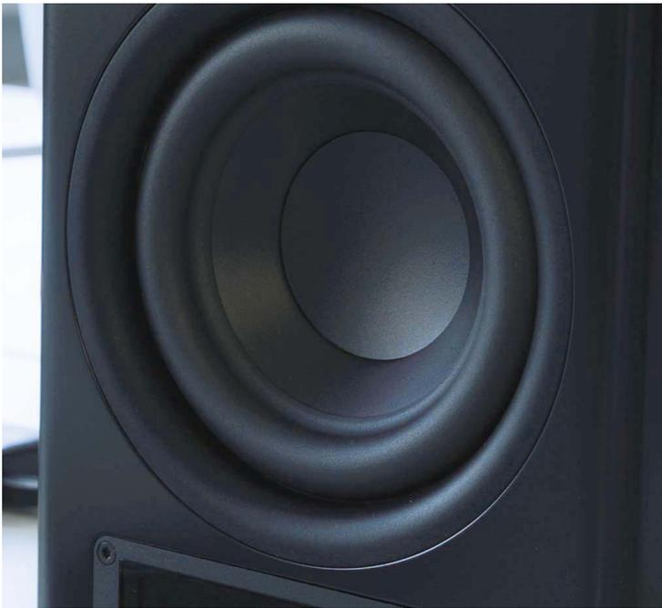
Der 17-Zentimeter-Woofer schallwandelt die Mitten und Bässe. Durch die kräftige Sicke kann seine Membran beim Schwingen weit auslenken.
