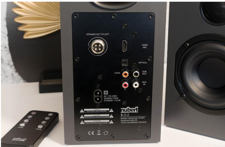
Das Anschlussfeld ist mit analogen und digitalen Eingängen ausgerüstet und befindet sich in der Masterbox.
