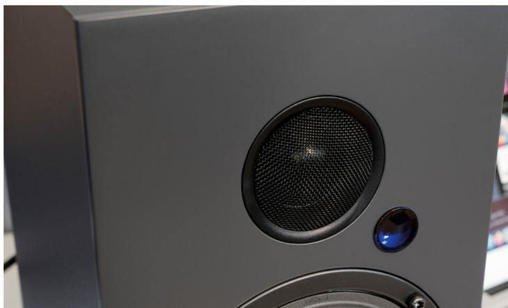
Der 25 Millimeter durchmessende Hochtöner sitzt hinter einem feinmaschigen Gitter. So ist er vor mechanischer Beschädigung geschützt.
